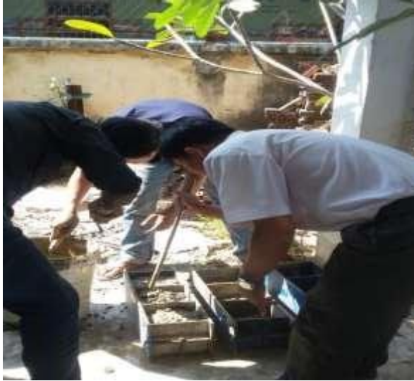
Hình 11. Đúc mẫu bê tông thí nghiệm M250
