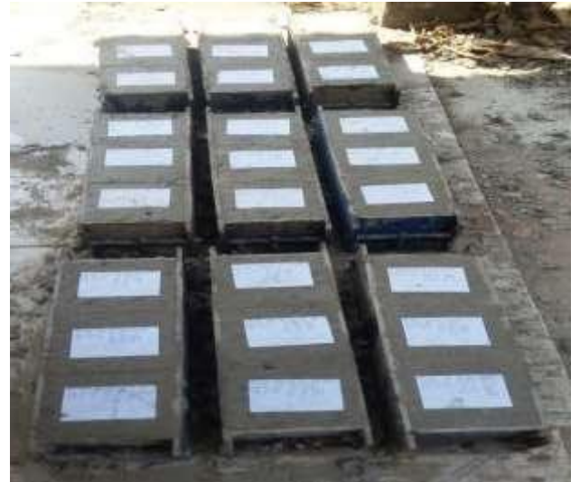
Hình 12. Mẫu bê tông M250 sau đúc
