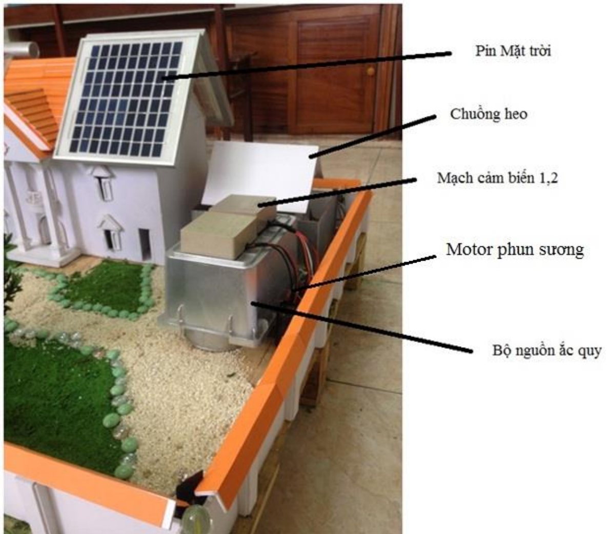
Hình 6. Một góc nhà mô hình có bộ nguồn ắc quy, cảm biến
